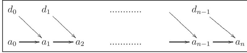
Figura 3: Algoritmo di trasformazione delle ondicelle inverso
